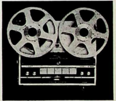
Model X-300. Professionele stereo band- recorder 3 motoren, 4 koppen, crossfield- opname systeem, 2 - 25 Watt eindverster- kers. Afm. 34 x 41 x 23 cm. gew. 21,3 kg. Prijs / 2.095,-
